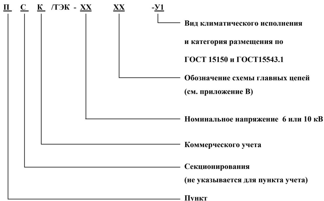
Пример записи обозначения пункта секционирования при их заказе и в документации другой продукции, в которой они могут быть применены: Пункт секционирования на номинальное напряжение 10 кВ, с коммерческим учетом и со схемой главных цепей С23 - "ПСК-10-С23-У1 ТУ 3414-019-18370720-13".
