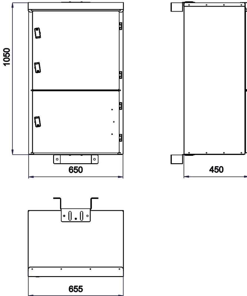
Рисунок б. Шкаф управления
