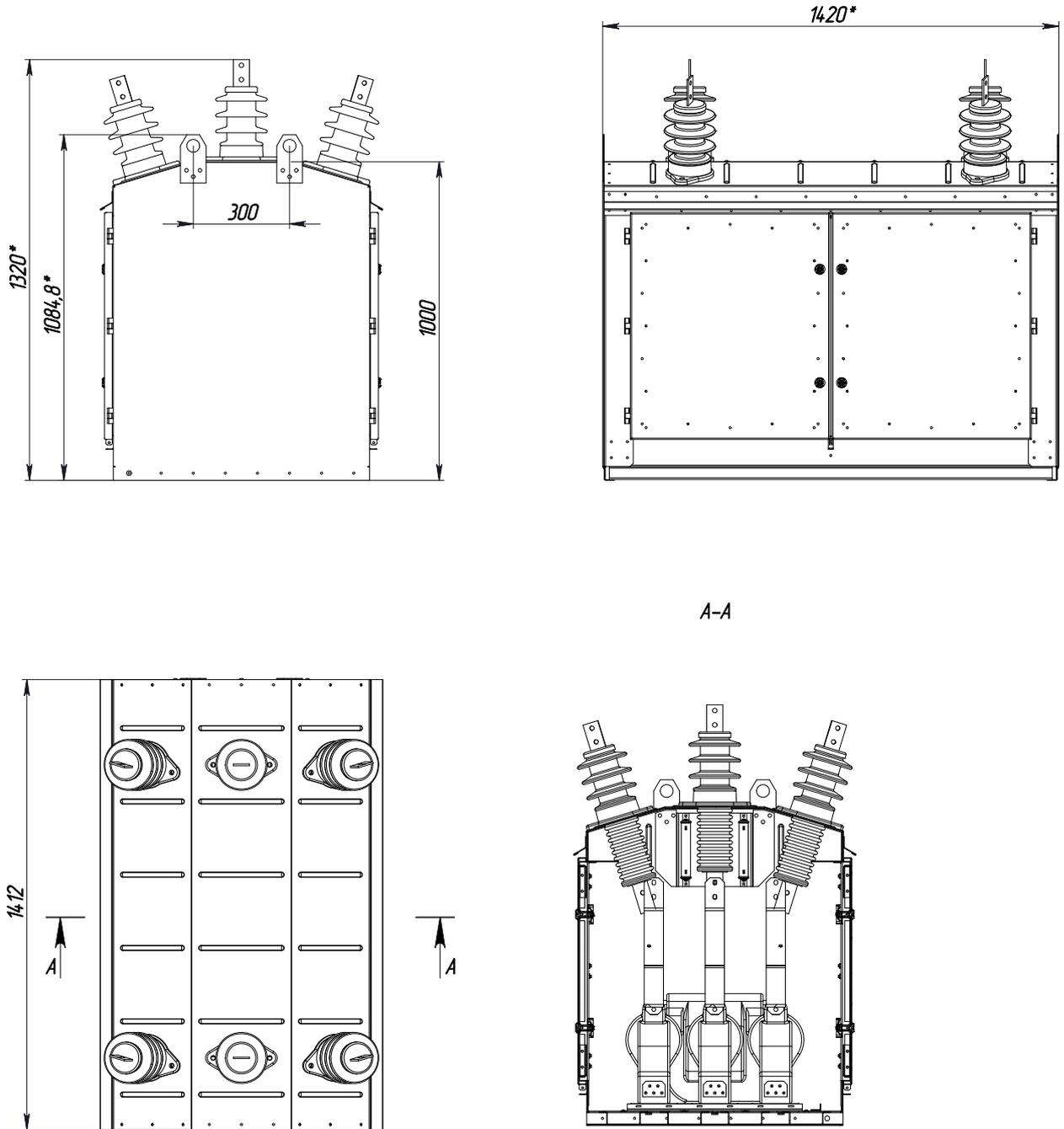
Рисунок а1. Пункт секционирования ПСК
