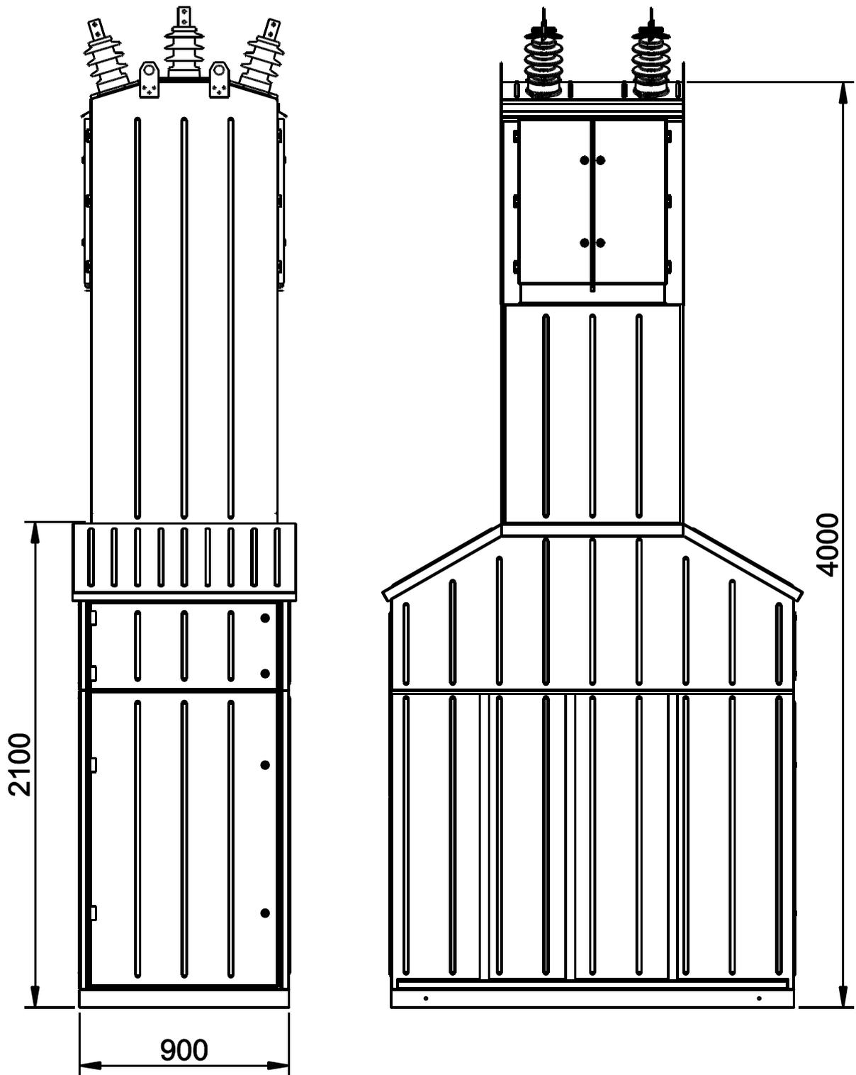
Рисунок а3. Пункт секционирования ПСК
