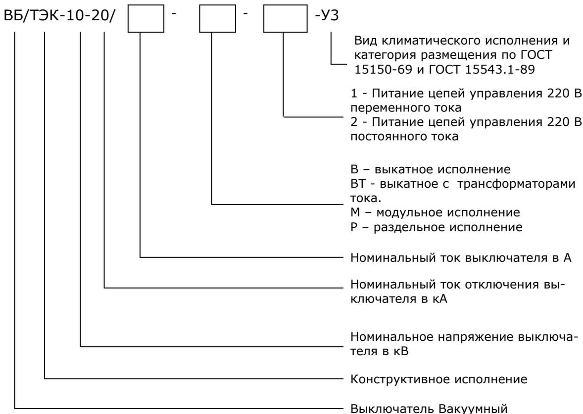
Пример записи: Выключатель вакуумный на номинальное напряжение 10 кВ, ток отключения 20 кА, номинальный ток 1000 А, в раздельном исполнении с питанием цепей управления переменным током - ВБ/ТЭК-10-20/1000-Р-1 УЗ.
