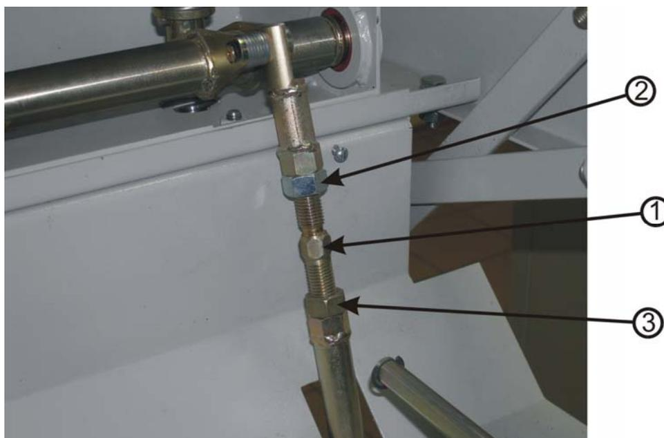
Фото 1. 1 – регулировочная шпилька; 2,3 – контргайки.
