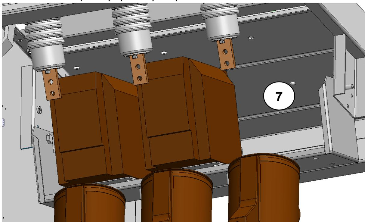
8. Провести демонтаж остальных трансформаторов.
