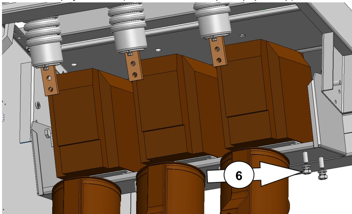
7. Снять трансформатор с кронштейном.
